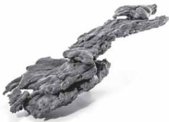
山田町焼山遺跡の製鉄炉跡に残っていた鉄滓。流れ出て固まった様子がわかります
